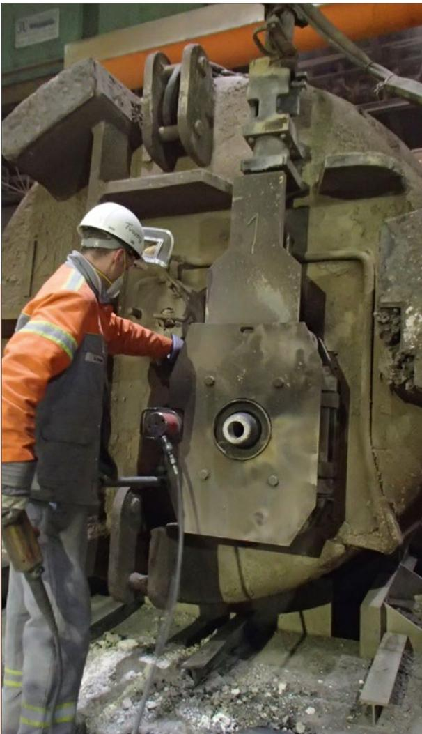
**Dreiplattenschieber am Pfannenplatz: Alle FT Varianten werden einfach mittels Spannzylinder gespannt und mit nur einem Verriegelungsbolzen verriegelt, dies ermöglicht einen schnellen Plattenwechsel.**
