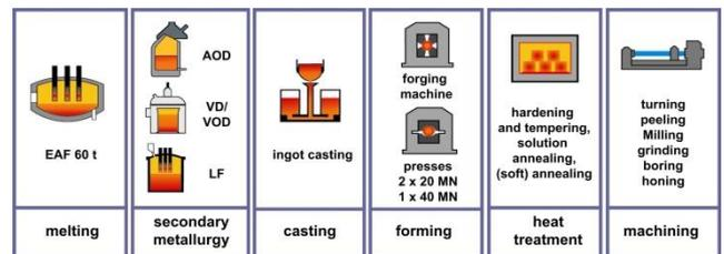
Figure 1: Production process of BGH Edelstahl Siegen GmbH
