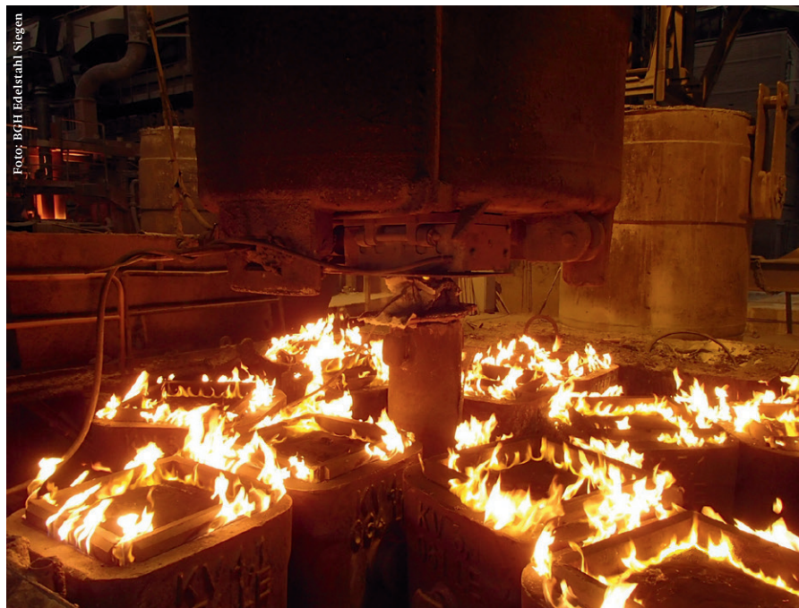
Beim Blockguss muss die Reoxidation während des Gießprozesses vermieden werden In ingot casting the pick-up of oxygen during the casting process has to be avoided
