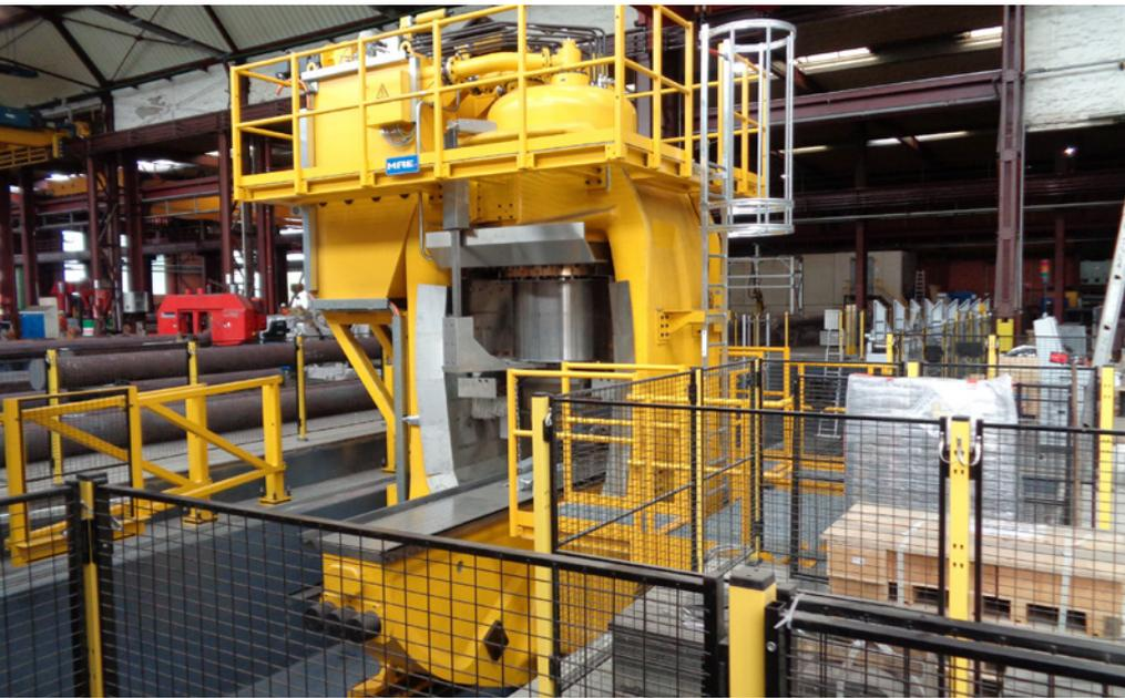
**Bild 7. Neu entwickelte automatische 40-MN-Richtpresse** (Foto: BGH Edelstahl Siegen)
